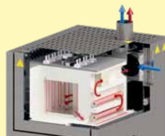
Illustrazione schematica della conduzione dell'aria nel forno combinato LHT 08/17 BO
