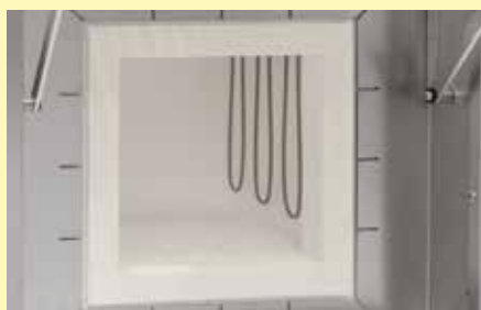
Camera del forno con materiale in fibra di alta qualità ed elementi riscaldanti in disilicuro di molibdeno su entrambi i lati
