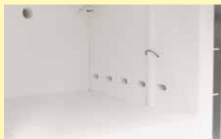
Camera del forno con prese d'aria per un ricambio d'aria in camera superiore alle 6 volte al minuto
