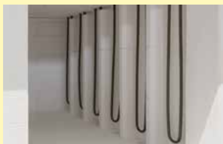
Protezione degli elementi riscaldanti per evitare danni meccanici durante il carico e lo scarico (dotazione aggiuntiva)
