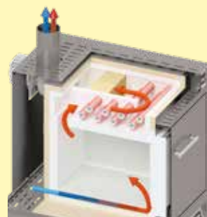
Rappresentazione schematica della conduzione dell'aria nel forno di incenerimento L 24/11 BO
