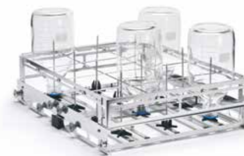
INS12U4180DV Inserto ad iniezione universale a 12 posizioni regolabili e supporto perimetrale. Adatto al lavaggio di 12 bottiglie con capacità fino a 1 litro o di 6 matracci fino a 2 litri.
