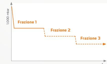
Con DAA si può iniziare un processo di distillazione completamente automatizzato già durante la fase di riscaldamento del bagno termostatico. La pressione del sistema viene adattata in modo dinamico alla temperatura mutevole del bagno termostatico, fino a che il bagno termostatico non ha raggiunto la temperatura impostata.
