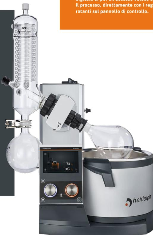
La velocità di rotazione e la temperatura del bagno termostatico possono essere impostate esattamente dal display touch digitale o, per un accesso veloce durante il processo, direttamente con i regolatori rotanti sul pannello di controllo.
