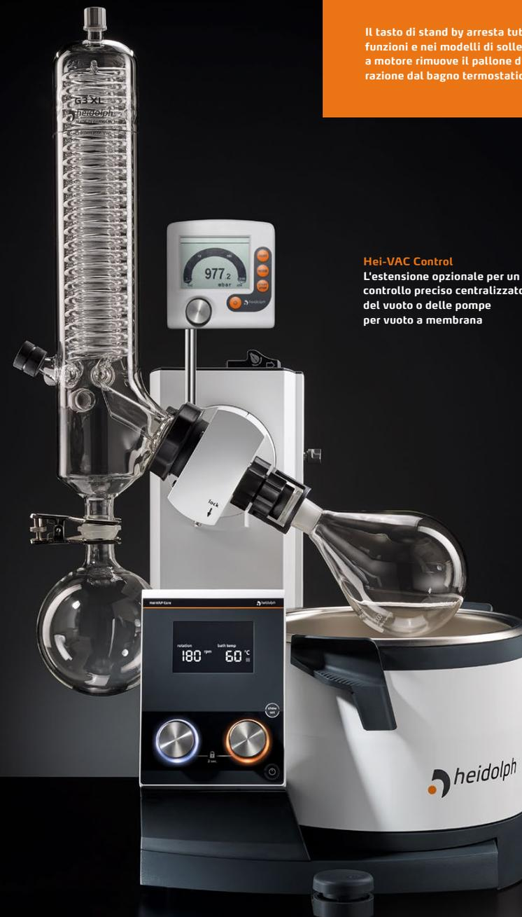
Il tasto di stand by arresta tutte le funzioni e nei modelli di sollevamento a motore rimuove il pallone d'evaporazione dal bagno termostatico.
