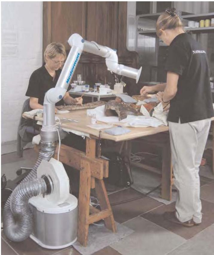
*Il braccio si monta con facilità grazie alla staffa per fissaggio a banco. In pochi minuti il kit di aspirazione è pronto per l'uso.*
