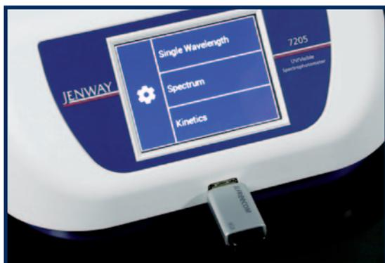
È possibile configurare lo spettrofotometro in modo tale da salvare automaticamente i risultati su chiavetta USB o stamparli in automatico utilizzando una stampante esterna.
