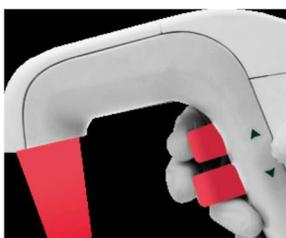
Quando lo stantuffo del dispensatore viene premuto leggermente, il pipettatore erogherà in modalità "gravità", durante la quale la pompa non è attivata ma la valvola di erogazione è operativa.
